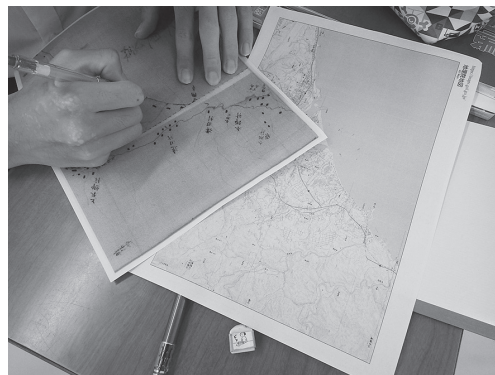
図10 「レイヤー法」の学習① 伊能図の海岸線と測線を地形図にトレース
